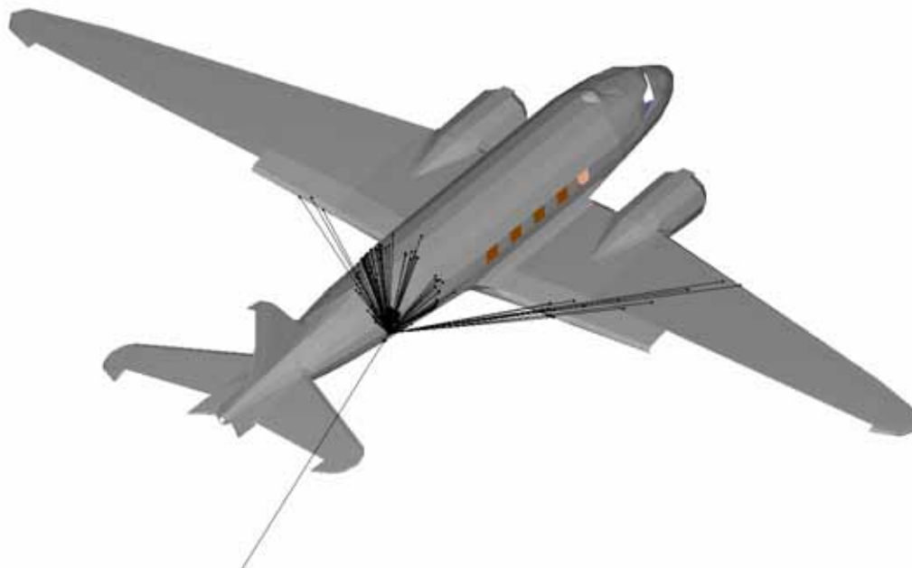
Figur 13: Splitterspridning från en simulering av skada 04. Notera att det i modellen saknas balkar och innergolv som verkligheten bör ha minskat splittertätheten i kabinen kraftigt.
