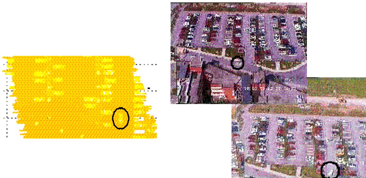
Figur 4. (a) En laserbild av en parkeringsplats. En viss bil är inringad. (b) Två visuella bilder av samma parkeringsplats och samma bil inringad. Metoder för association måste användas för att koppla samman bilen från de olika mättillfällena och från de olika sensorerna.
