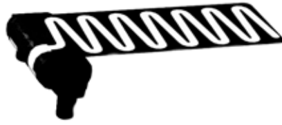
Figur 6.2: Meanderantenn - metalledare tryckt på ett dielektriskt substrat.
