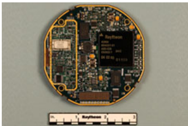
Figur 4.6: Bild av RAPTOr-III mottagaren från Raytheon.
