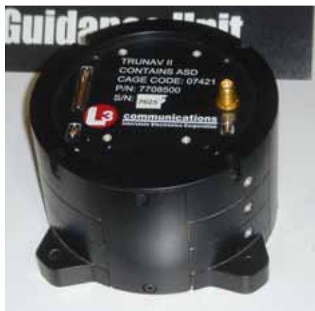
Figur 4.4: Bild på TRUNAV™, ett ultratät GPS/TNS-navigeringssystem från L3-Communications Interstate Electronics Corporation.
