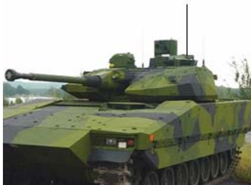
Figur 3: För att sensorsystemet skall tillföra någon större nytta bör det anslutas till ledningssystemet. Sensorn är placerad högst upp på fordonet och anslutningen till ledningssystemet kan ske med en antenn monterad bredvid.
