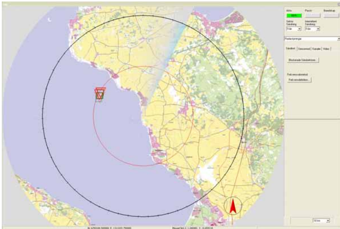
Figur 13 Remсор har kastats och registrerats av spaningsradarn. Röda trianglar är målsår som genereras ur observationer mha ett kalman filter, gröna trianglar är observationer.
