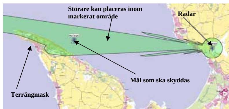
Figur 6 Radarsensorn kan inte detektera målet om en störare placeras inom markerat område.
