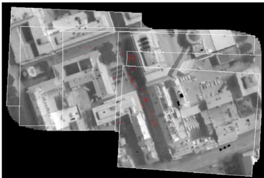
Figur A.7: Detektion av små rörliga mål (människor) via rörelsekompensering kan ske samtidigt som systemet genererar en videomosaik av bildsekvensen. Scenen innehåller påtaglig 3D-struktur och en kompletterande databas med geoinfo i kombination med navigationsdata från plattformen har nyttjas för att enbart söka rörliga objekt på marken. Bilddata består av en IR-sekvens över Linköping stad.
