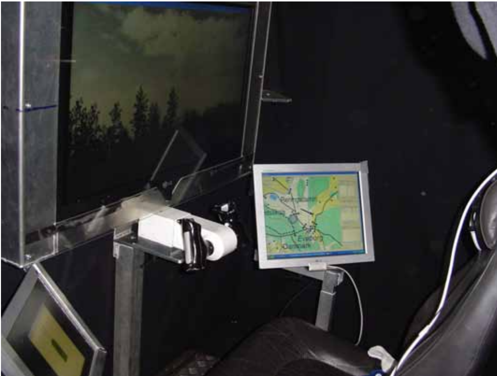
Figur 7 visar interiör från rörelseplattformen med ledningsvyn till höger, i mitten visas en utblick från tornet och till vänster skymtar den grafiska presentationen av varningsvyn.
