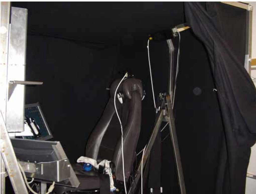
Figur 8 visar en interiör bild från rörelseplattformen med olika gränssnitt (taktilt bälte och 3D-ljud) för att presentera varningar för operatören. Det taktila bältet ligger på stolsätet och hörlurar för 3D ljud hänger på ryggstödet.
