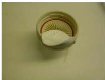
Figur 5. Provtagningsutrustning. De övre bilderna visar provtagningssträtt och luftpump. De nedre visar filter och filterhållare.
