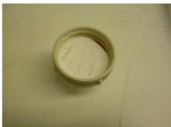
Figur 5. Provtagningsutrustning. De övre bilderna visar provtagningssträtt och luftpump. De nedre visar filter och filterhållare.
