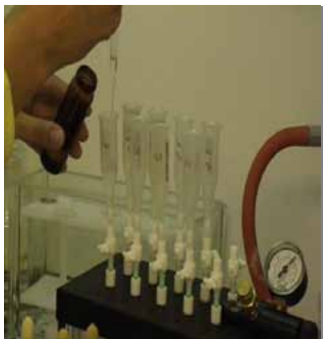
Figur 3. Explosivämnet koncentreras och renas på en SPE, försöksupställning med SPE
