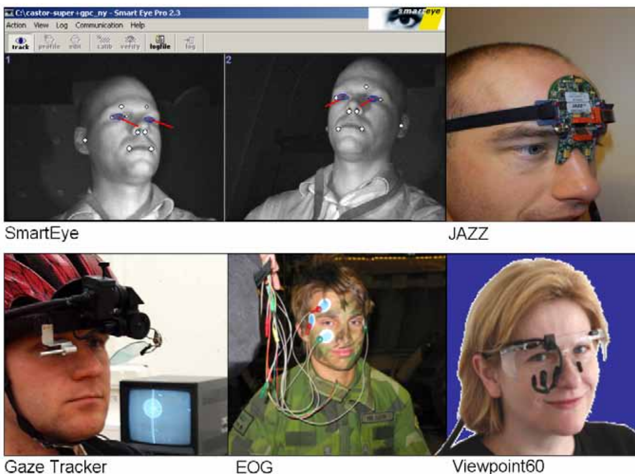
Figur 2. Exempel på utrustning hos FOI som används för att registrera olika typer av ögonaktivitet.
