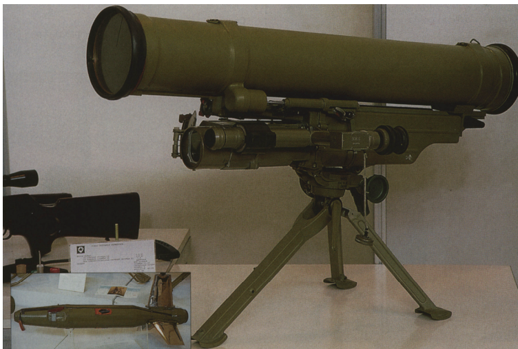
Figur 2 METIS-2 med robot och siktesenhet monterad på tripod.
