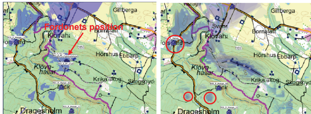
Figur 36 Vänstra bilden: siktdiagram från aktuell fordonsposition till omgivande terräng. Högra bilden: överlagrade siktdiagram längs den norra vägen. De röda cirklarna markerar områden som ser mest av vald framryckningsväg.
