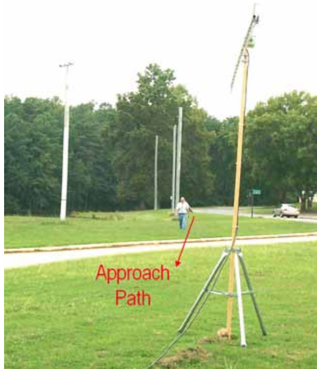
Figur 44. Foto visar experiment för att detektera människor och fordon med passiv radar:
