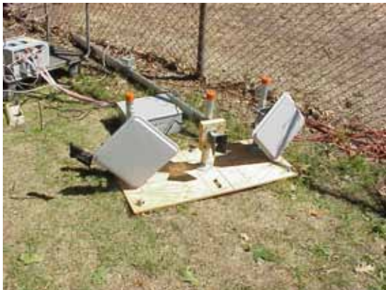
Figur 32. Figuren visar till vänster antennerna till en 3.5GHz markvågsradar från ESL/OSU [4] som kan användas för avbildningar av rörliga objekt, även i vegetation och bakom väggar. Till höger visas detektioner av människor gjorda med systemet.
