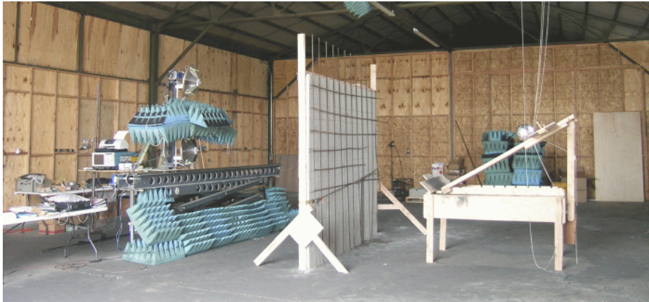
Figur 35. Fotot visar ImpSAR-systemet från Eureka Aerospace under mätningar genom en armerad vägg.
