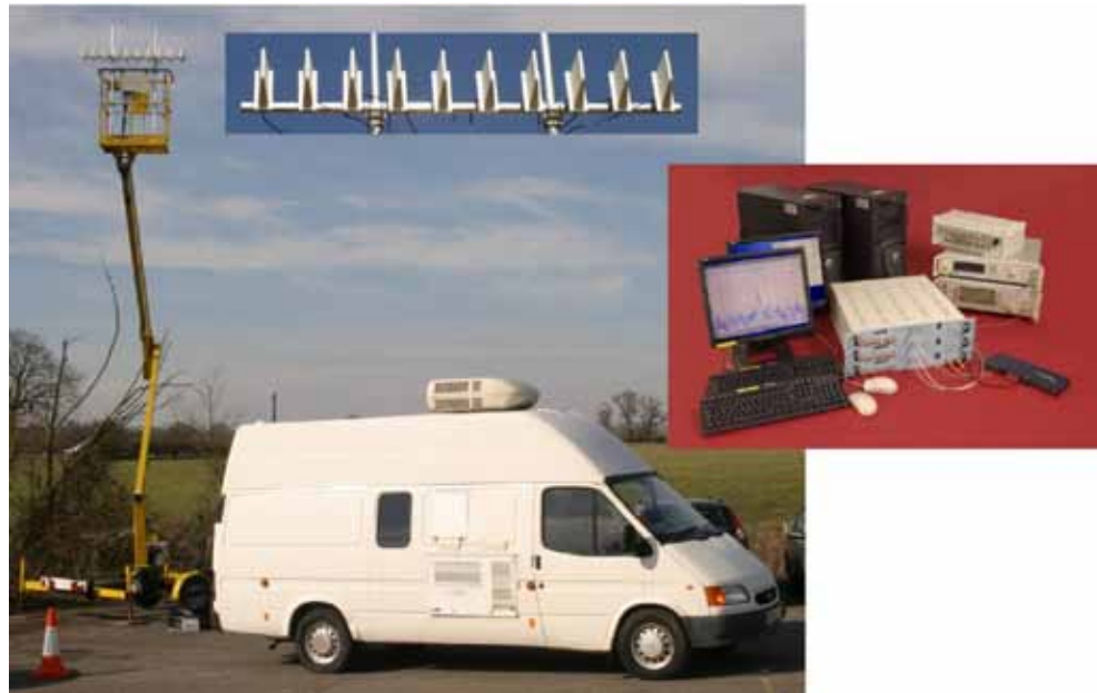
Figur 42. Demonstrator av mottagningsstation för CELLDAR systemet vid trafikflödesmätningar.
