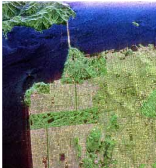
Figur 67. Polarimetrisk SAR-bild över delar av San Francisco registrerad med NASA/JPLs flygburna system AIRSAR. Olika bakgrundstyper ger olika polarimetriska signaturer, som i detta fall vattenytor (blått), vegetation (grönt) samt stadsbebyggelse (ljus hög intensitet). ( www.vexcel.com ).
