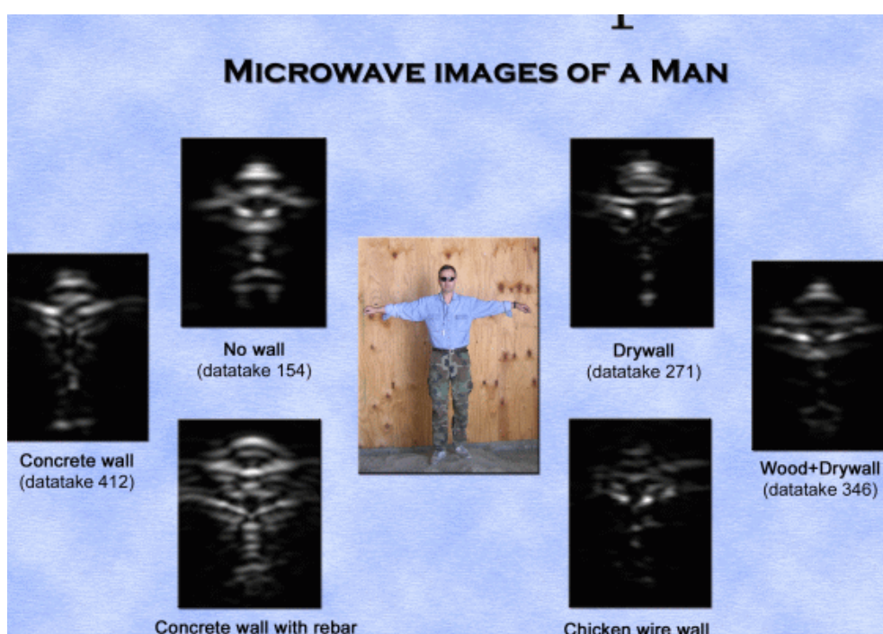
Figur 39. Fotot visar SAR-bilder av en man bakom olika slags väggar avbildad med ImpSAR-systemet.
