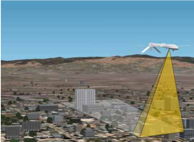
Figur 66. En UAV-plattform försedd med en 3D-SAR för avbildning av ett markområde där effekten av skuggor från skymmande objekt som radarstrålningen ej penetrerar kan minimeras genom en geometri med branta infallsvinklar 75 .
