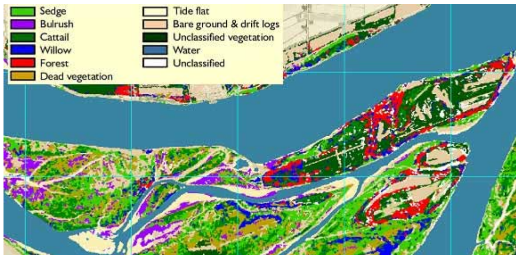
Figur 9. Bilden visar ett exempel på klassificering med hjälp av hyperspektrala satellitdata.
