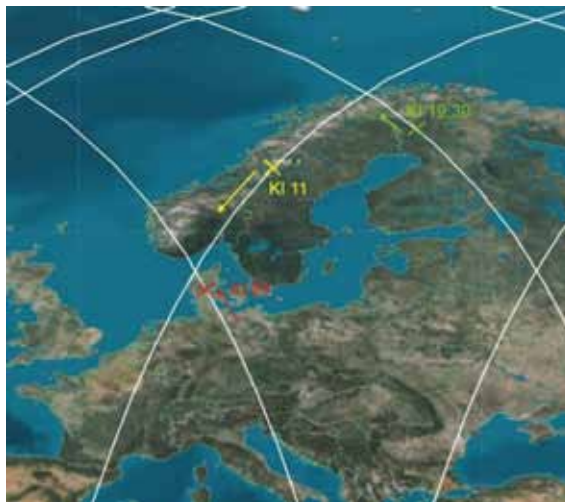
Figur 7. Bilden visar principen på hur optiska satelliter vanligen passerar Sverige. Exemplet visar en SPOT-satellit som passerar över Europa under ett dygn Kvällstid passerar satelliten Sverige i sydlig riktning och på förmiddagen nordlig riktning. På grund av dagsljus och atmosfärförhållanden sker bildtagning oftast förmiddagen.
