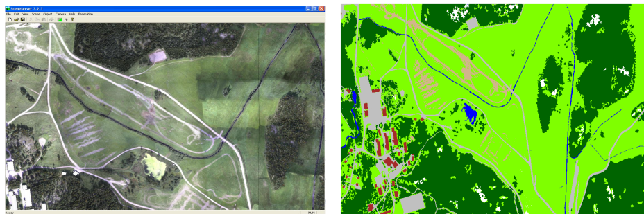
Figur 4.18: Bilden till vänster visar en bild av en modell av ett terrängavsnitt. Bilden till höger visar hur olika material i detta terrängavsnitt kan koderas med olika färger. Dessa färgkoder översätts sedan till detaljerade materialbeskrivningar i de simuleringsverktyg som används för att simulera olika sensorer i 3D-modellen av terrängavsnittet.
