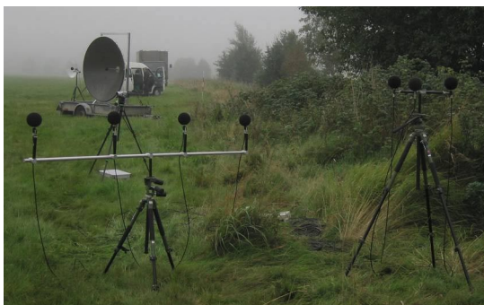
Figur 4.17: Akustiska arrayer samt parabolmikrofoner
