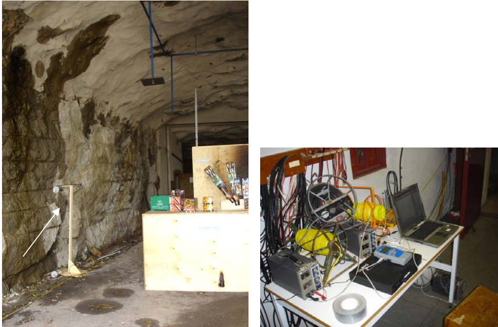
Figur 8. Placering av optisk densitometer vid sidan av försäljningsdisken (vid pilen) samt dataloggningsutrustning.
