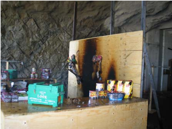
Figur 13. Stängd trälåda (LOOK) klarade brand/värmestrålning mycket bra vid båda sprinklerförsöken.
