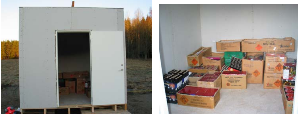
Figur 3. Rum med EI 30-klassade väggar samt fyrverkeripjäsernas placering före försöket.
