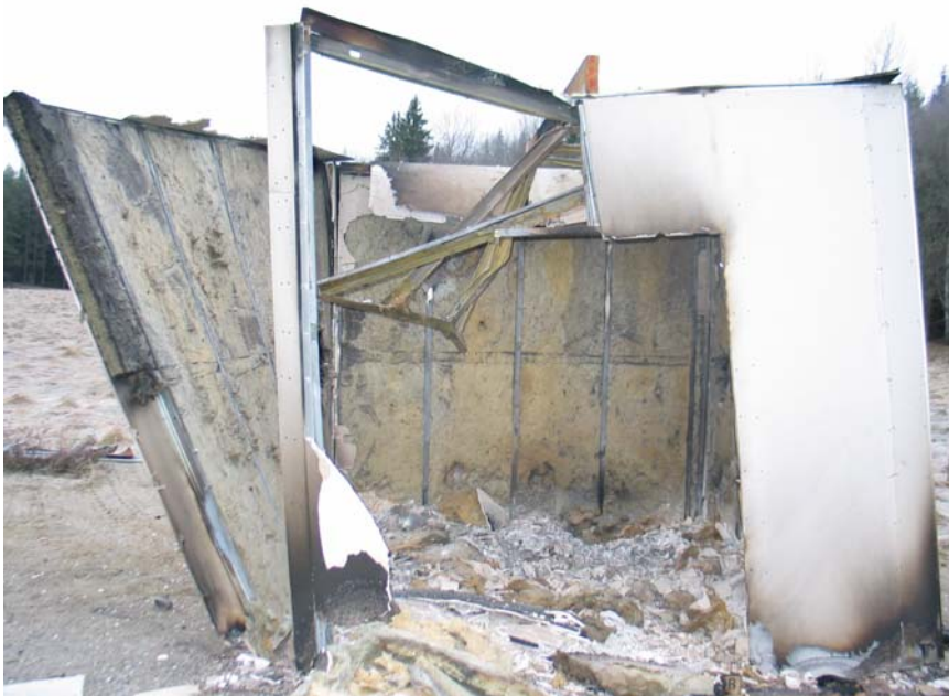
Figur 4. Rum med EI 30-klassade väggar efter brandförsöket.
