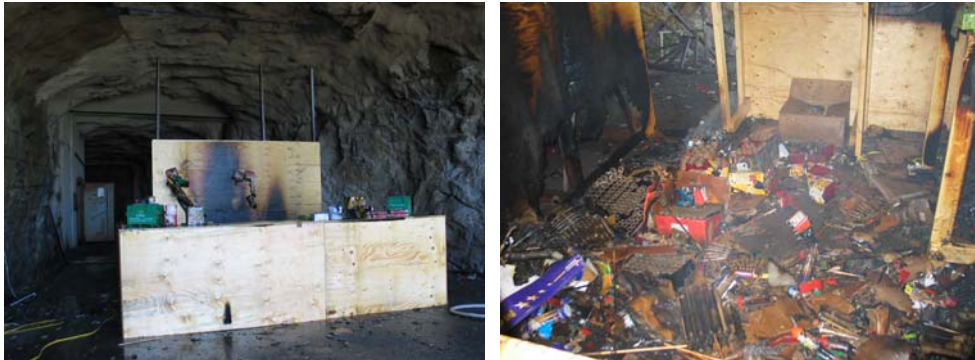
Figur 12. Försäljningsdisk angripen av brand efter sprinklerförsök 1.
