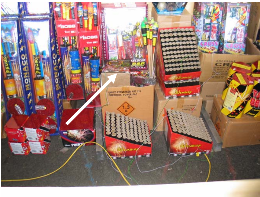
Figur 11. Branden initierades genom anfyrring av initieringstårta placerad vid pilen.
