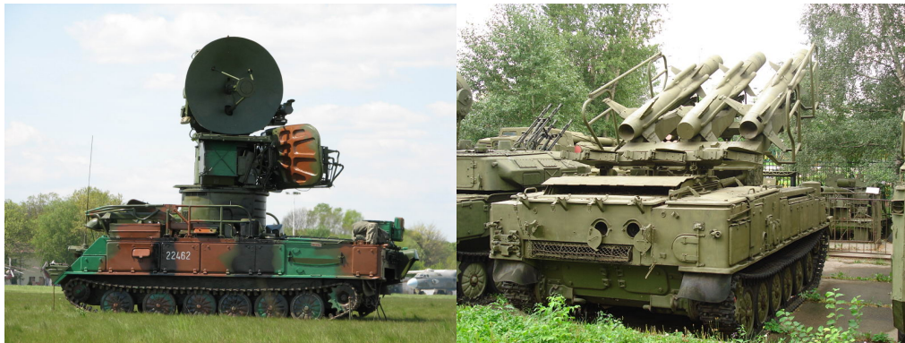
Figur 3 Det mediumräkviddiga (<28 km) ryska lrb-systemet SA-6 "Gainful". Bilden till vänster visar TAR/TTR. Den högra bilden visar en TEL med 3 robotar.
