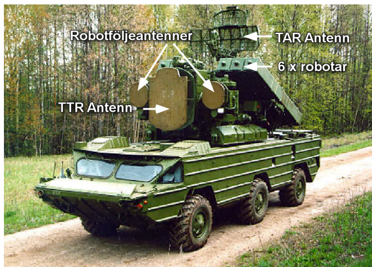
Figur 6 SA-8 "Gecko" med TAR-antenn, TTR-antenn, robotföljeantennor och 6 stycken robotar.
