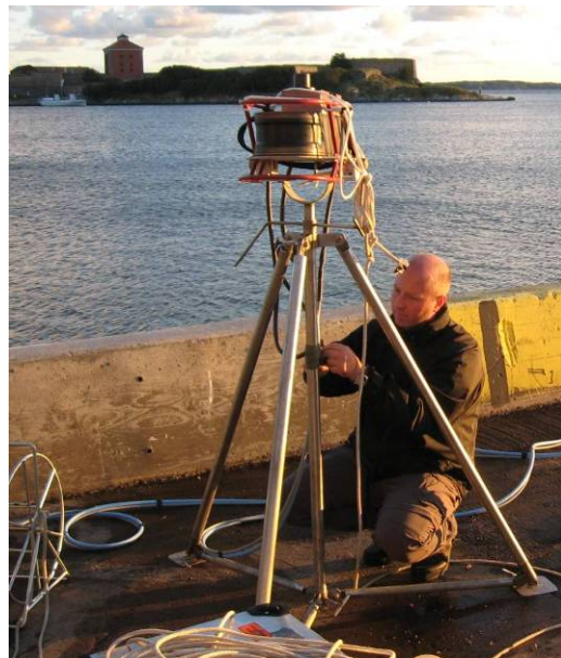
Figur 1. Hamnsonar SeaBat 6012 monterad på ett stativ som justerades så att sonaren var fixerad 2,5 m över botten under försöket i Göteborgs hamn.
