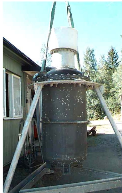
Figur 10. Sonar 390, C-Tech system CSAS-80. Den övre rostfria delen är sändar- och mottagadel, den gröna undre delen är elektronik- och kopplingsdel. Storleken gör att systemet är lämpligast för fast installation, med stativet är våtdelen ca 3 m hög
