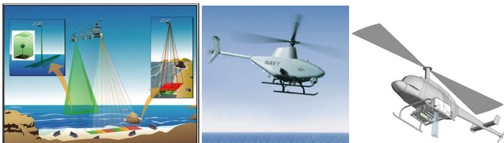
Figur 42. ROAR systemet och dess mission som är minsparing i grunda vatten och på stranden. Volym, vikt och elektrisk effekt uppges vara 0,05 m 3 , 125 kg respektive 2,5 kW. Källa Lite Cycles.
