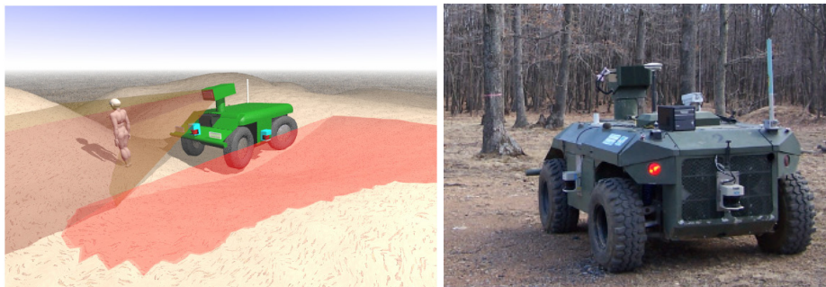
Figur 62. Tv. En tecknad bild och t.h. ett foto av fordonet med installerade laserlinjeskanners på sidorna och bakåt och en 3D-flash sensor på ett pan-tilt huvud. Från ref. [113].
