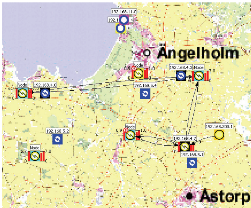
Figur 3. Kartvyn för kommunikationsnätverk i LKS Stab. Staplarna vid sidan av ikonerna visar på aktivitetsnivå. Ett rött utropstecken i hörnet av en ikon visar på att en varning registrerats för objektet.
