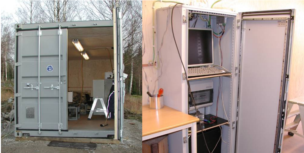
Figur 8 Till vänster container för tomografering, till höger styrcentralen för tomografisystemet.
