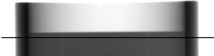
Figur 17 Röntgenbild, svarta strecket är snittet som tomogramet i figur 18 är gjort av.
