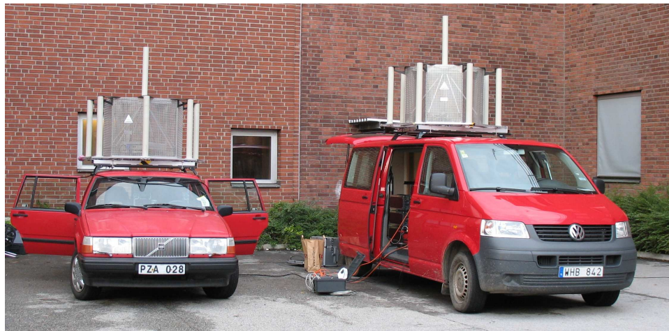
Figur 3.2: Antennarrayerna monterade på sändarbil (till vänster) och mottagarbil (till höger).
