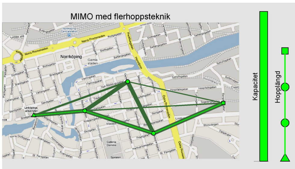
Figur 12 Radiolänkar mellan de olika enheterna. Tjockleken på linjerna svarar mot kapaciteten i länken. Den ljus gröna linjen visar vald väg i nätet för videoöverföringen
