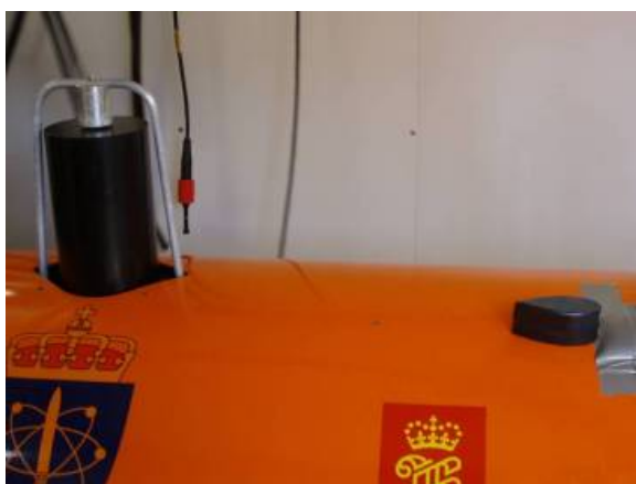
Figur 1. UCAC-modemet integrerat ombord på Hugin, till vänster, moderfartygets modem till höger.
