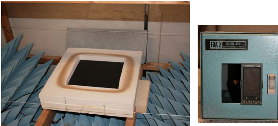
Figur 5. Foto på värmeplattan och kontrollenhet.
