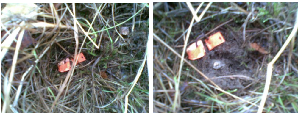
Figur 5. Här visas en bild av hur plaströrens placering har markerats och en bild där plaströret frilagts vid provtagning.
