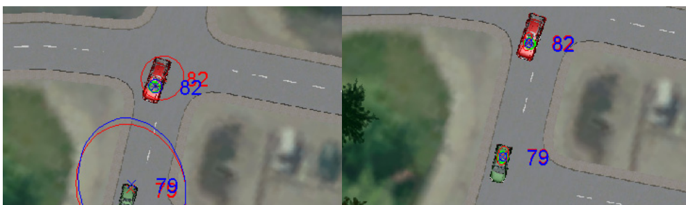
Figur 31. Två fordon färdas längs en väg i Norrköping. I den första bilden har den gröna bilen inte detekterats. Osäkerheten för det predikerade målet med identitetsnummer 79 är därför stor vilket illustreras av cirklarna som omger prediktionen. I den andra bilden har den gröna bilen detekterats och osäkerheten gällande dess tillstånd har därmed minskats.
