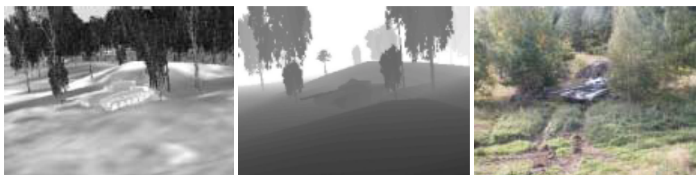
Figur 21. Till vänster visas en simulerad reflektansbild för en stridsvagn T72. I mitten visas en simulerad avståndsbild där ljusare bildpunkter är längre bort. Till höger visas ett foto som visar 3D-lasersensorns synfält.
