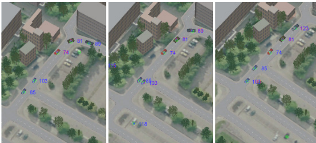
Figur 30. Bildsekvens från simulerat scenario i Norrköping: fyra fordon färdas i kolonn och måste köra om den parkerade bilen som i bilderna indikeras av målsparidentitet 85.
