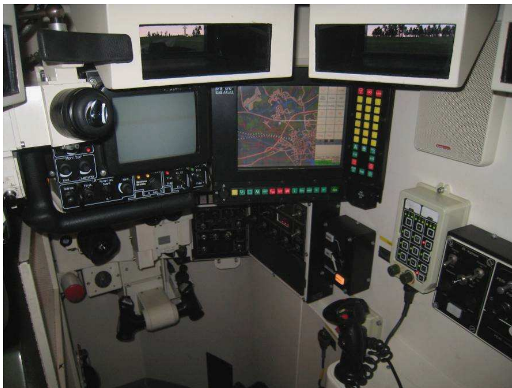
Figur 6. Vagnchefsplats Strv122 med bl.a. prismor i övre del av bild och TCCS rakt under prismorna. Nedanför vagnchef sitter skytt. Bild från Besättningsträningsanläggning BTA, P4 Skövde.
