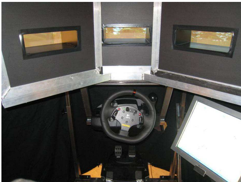
Figur 14. Förarplats i MSI lab med utblickar, ratt, pedaler och SLB-skärm nere till höger.
