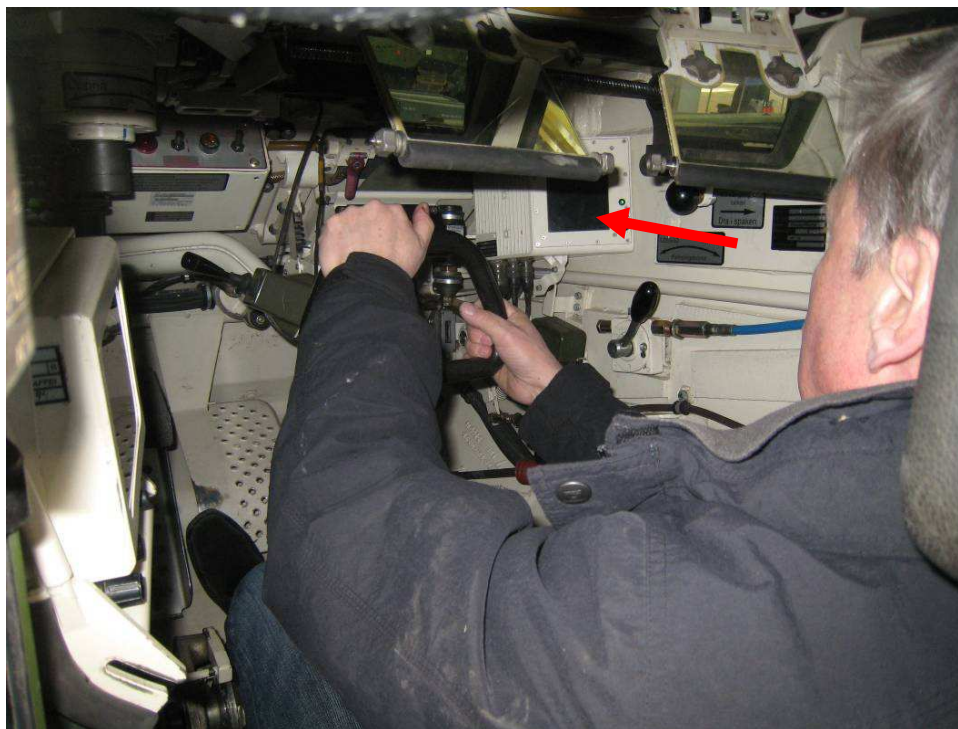
Figur 9. Förarplats Stridsvagn 122. Speglar för prismor nerfällda. Navigeringsdisplayens placering indikeras med pilen.
