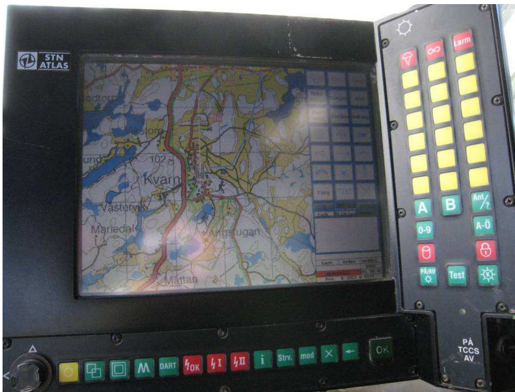
Figur 7: TCCS med karta och funktionsknappar. Från P4 Skövde.
