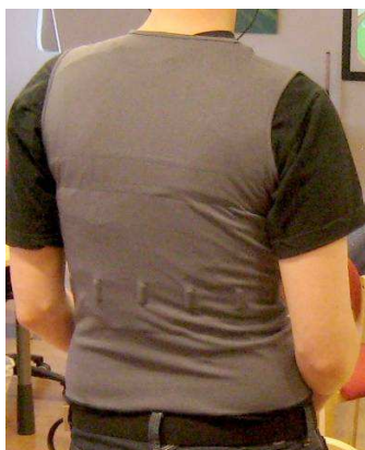
Figur 12. Taktisk väst FOI TV till vänster, och taktiskt bälte till höger. Västen medger möjlighet att placera taktorer i flera ringar vertikalt så både horisontell och vertikal information kan ges.
