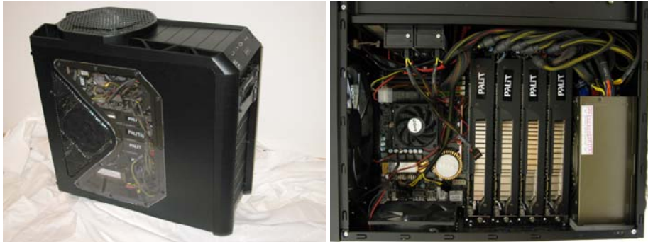
Figur 5: Grafikkortsberäkningsdatorn Calculix (till vänster) och dess inandöme (till höger).
