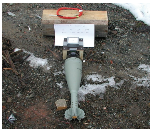
Bild 7. Avslagare i skjutbord, färdig för skott enligt försöksuppställning 2
