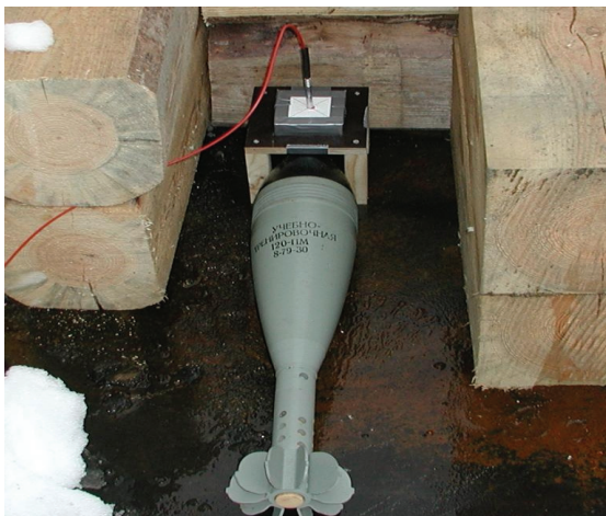
Bild 2. Avslagare placerad i skjutbord ovan granat.
