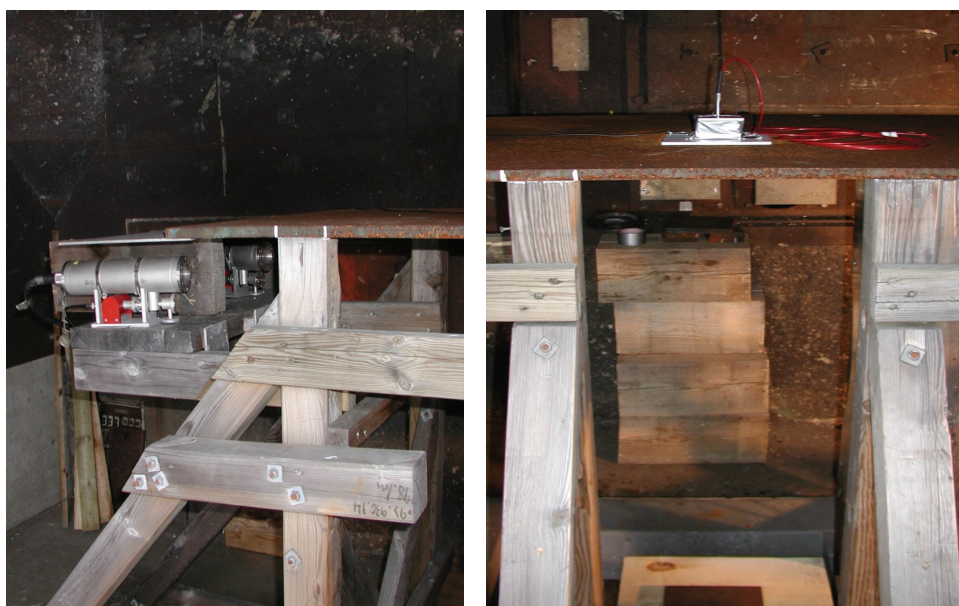
Bild 4. Försöksuppställning Vänster bild - röntgenblixtrar. Höger bild - skjutbord med laddning
