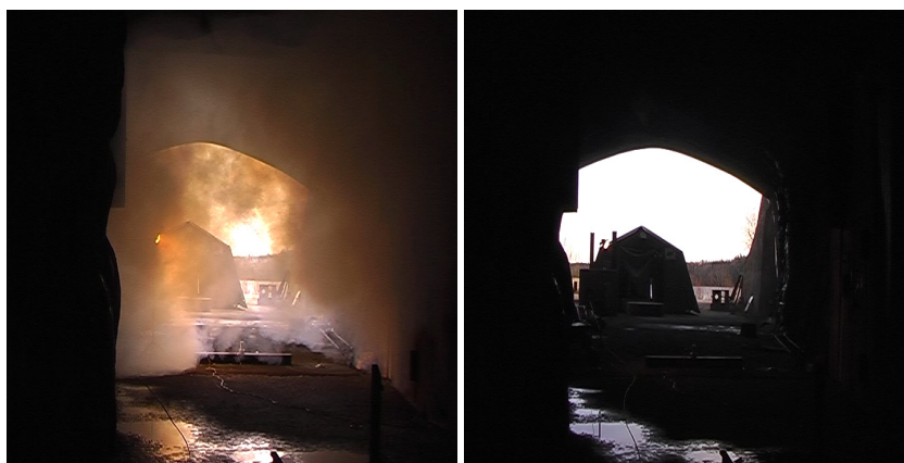
Figur 5. Förbränningsexperiment med rykande ammoniumperklorat-baserat kompositkrut (t.v.) och rökfritt ammoniumdinitramid-baserat kompositkrut (t.h.).
