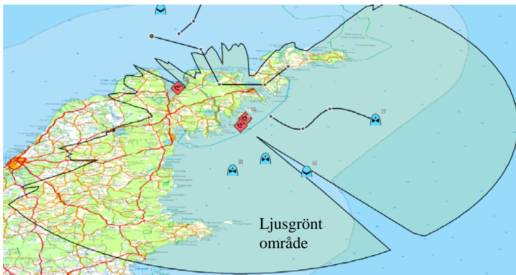
Figur 23 Ljusgrönt område visar täckning för en PS861 placerad på östra sidan av Gotland.
