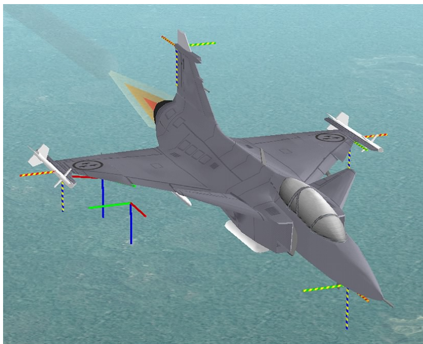
Figur 17 Det störsändande flygplanet utrustat med 4 arrayer (randiga koordinataxlar) samt 3 horn (halfärgade koordinataxlar). Som visas i figuren kan ett antennsystem positioneras utanför flygkroppen.
