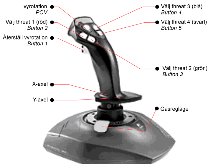
Figur 5 Knappar som styr simuleringen om styrspaksmodell används. Use flp model # = 1 under fliken Aircraft, se kapitel 2.3. Visad joystick "Logitech Wingman Extreme 3D".
