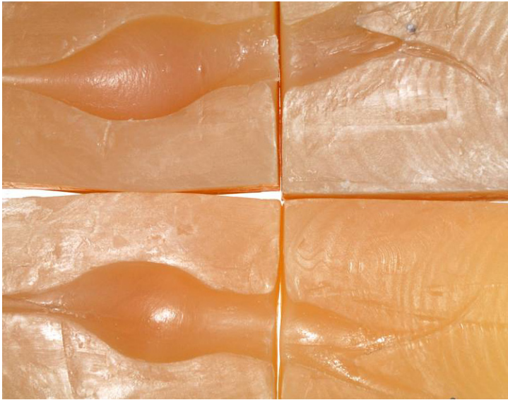
Figur 8: Exempel på en kavitetsprofil i tvålvilken används för att analysera projektilers egenskaper i mjuka mål.
