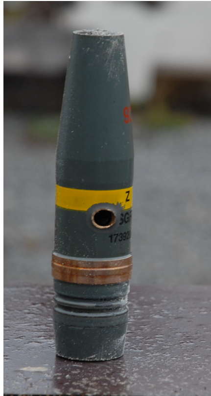
Figur 13: Resultat från ett av försöken, en granat där sprängämnet inte har reagerat.
