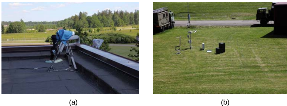
Figur 12 (a) Agema 900SW och LW värmekameror under mätning av CUBI. (b) CUBI och väderstation sedda ur kamerornas perspektiv.
