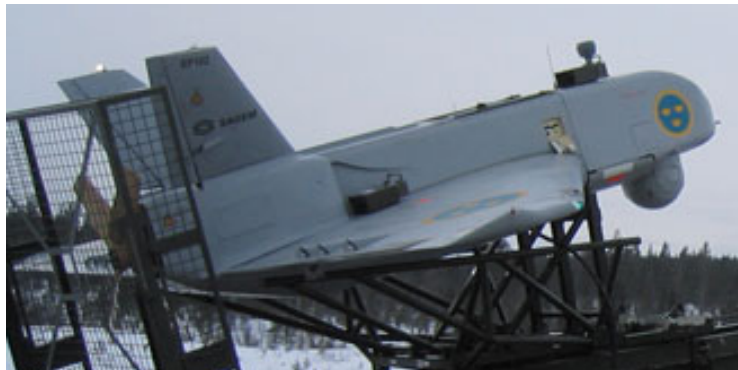
Figur 23. UAV-systemet Ugglan med aktermonterad 4-bladig propeller.
