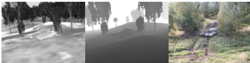
Figur 31. Till vänster visas en simulerad reflektansbild för en stridsvagn T72. I mitten visas en simulerad avståndsbild där ljusare bildpunkter är längre bort. Till höger visas ett foto som visar 3D-lasersensors synfält.
