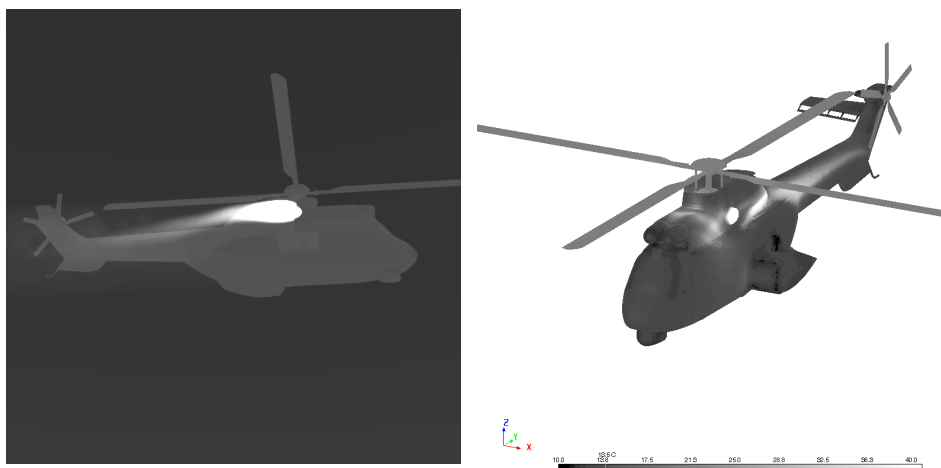
Figur 14. Hkp 10 modellerat med SE-RAY-IR respektive RadThermIR. Dessa signaturbidrag måste kombineras för att alla signaturbidrag ska fås med, se text ovan.
