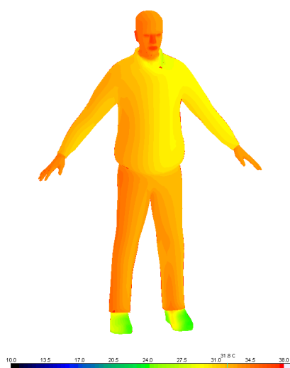
Figur 16. Modellering av människa med en förenklad ansats där innertemperaturen är låst till 37° C. Modellen är solbelyst från ena sidan och den har olika tjocka luftlager mellan kropp och kläder.
