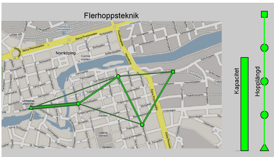
Bild 5.3: Samma ögonblicksbild som i figur 5.2 för fallet med flerhoppsteknik. Genom att reläa trafiken med 4 hopp för att erhålla maximal kapacitet når videofilmen basnoden.
