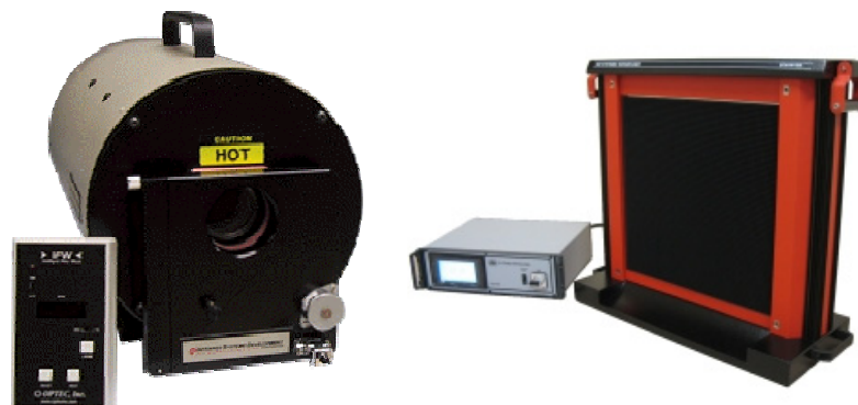
Figur 10. Exempel på traditionella svartkroppsstrålare; kavitetsstrålare (vänster) [Bildkälla: http://www.hgh.fr ] och ytstrålare (höger) [Bildkälla: http://www.infraredsystems.com ].
