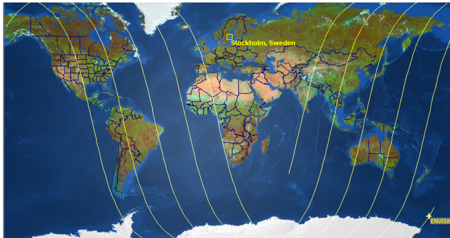
Figur 1-3. Exempel på banspår. Bilden visar ESAs miljöövervakningssatellit Envisat som ligger i en solsynkron bana på 800 km höjd med en omloppstid på 101 minuter. Banspåret på bilden motsvarar fem varv runt jorden.
