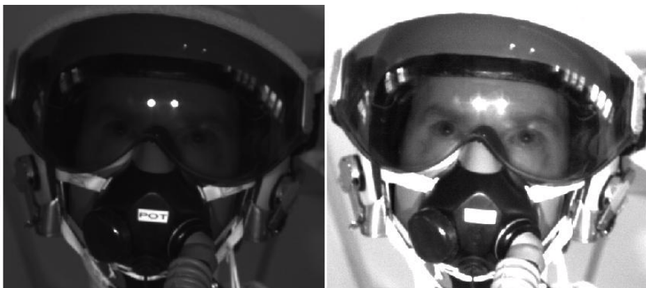
Figur 5: Bilder från test med solvisir. Till vänster rå och oförstärkt bild tagen av SmartEye-systemet, visande pilot med nedfällt solvisir. Till höger samma bild, men intensitetsförstärkt. Bilden illustrerar tydligt att bildinformationen finns tillgänglig även bakom solvisiret, och att solvisiret inte förhindrar blickriktningsmätning. Viss ökad brusighet i bildinformationen är att förvänta vid sådan förstärkning, men detta bör inte nämnvärt påverka mätdatakvaliteten.
