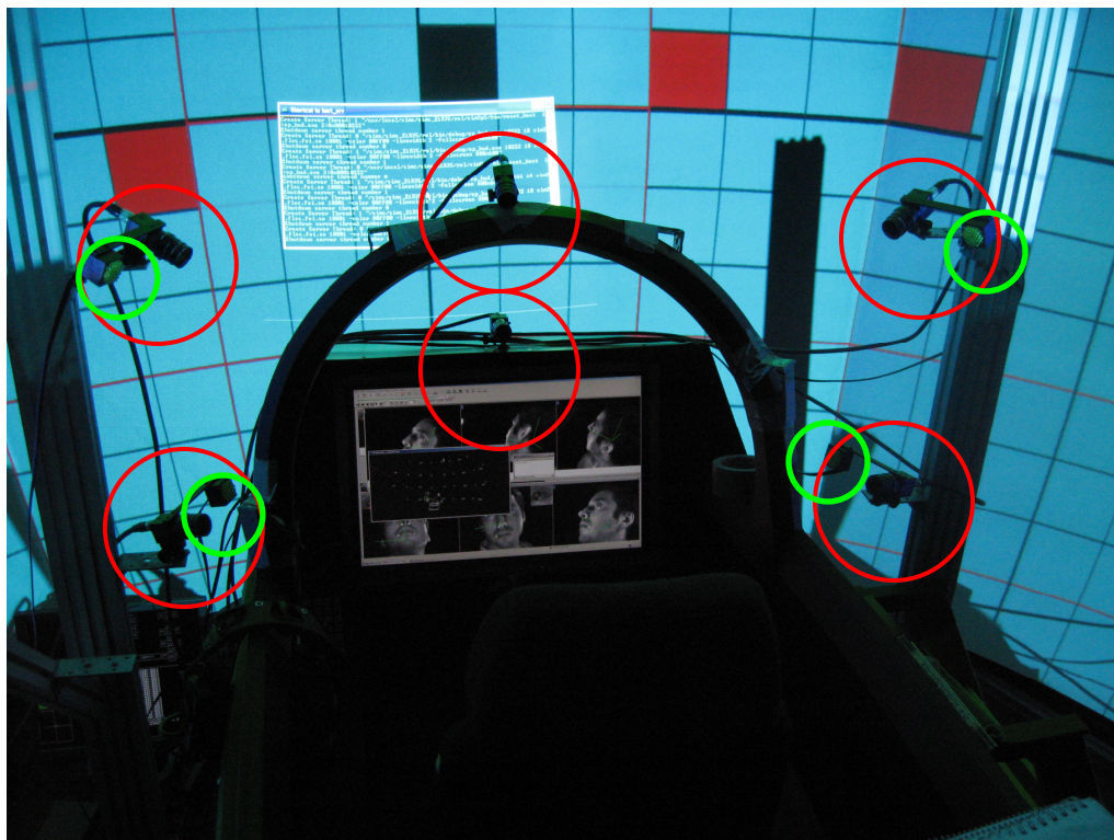
Figur 6: 6-kamerasystem monterad i simulatorkabin med markerade kameror (röda cirklar) och flashar (gröna cirklar).
