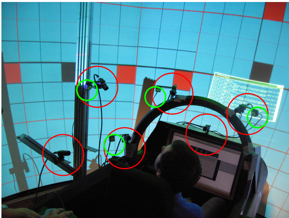
Figur 7: Simulerat 9-kamerasystem monterad i simulatorkabin med markerade kameror (röda cirklar) och flashar (gröna cirklar).
