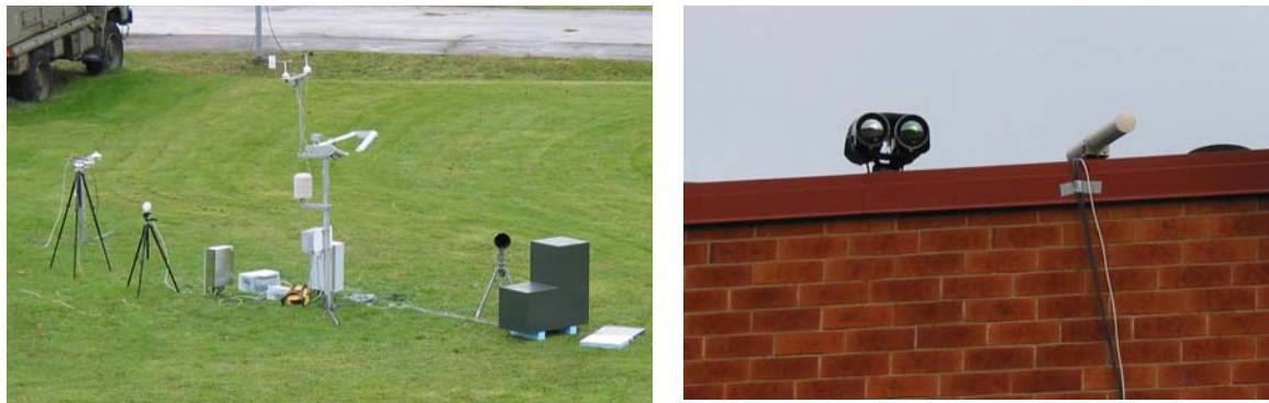
Figur 7 Till vänster visas ett foto på CUBI-uppställningen sedd från värmekamerornas position. Till höger visas ett inzoomat foto av IR-kamerorna sett från CUBIn.
