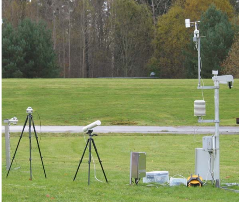
Figur 4 Väderstation VAISALA Milos 500. Den vita tuben mitt i bilden är en kommunikationsantenn som används för trådlös överföring av alla väderdata till datainsamlingsdatorn. Till vänster i bilden ses ett antal solinstrålningssensorer.
