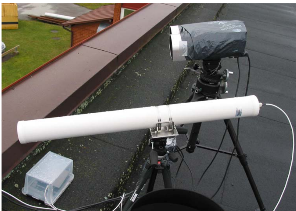
Figur 6 Placering av värmekameror på taket av FOI-huset. Den vita tuben är en kommunikationsantenn som används för att ta emot väderdata från väderstationen och ytemperaturdata från CUBI.
