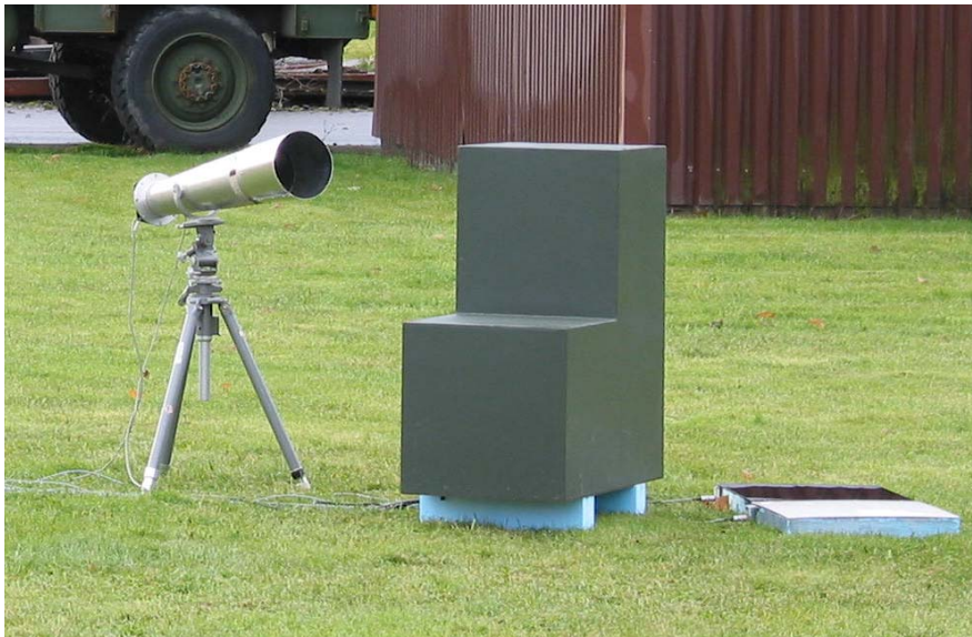
Figur 8 En närbild av CUBI med de två referensplattorna liggande till höger. CUBI är placerad på två klossar av isoleringsmaterial (typen frigolit). Trattan till vänster om CUBI används som kalibreringsobjekt. En temperaturgivare är monterad i trattens avslutning och läses av varje minut. Trattan är riktad mot kamerorna så att kamerorna ”ser” trattens avslutning.
