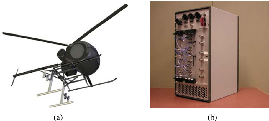
Figur 11. (a) Illustration av prototypen för CARABAS-3 på liten helikopter enligt SAAB:s design. (b) Elektroniklåda för CARABAS-3 som innehåller radarstyrning, sändare, mottagare samt datalagring. Antenner, kablar samt sensorer för positionering (GPS och IMU) tillkommer vid installationen.
