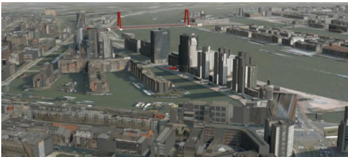
Figur 2. CityGML-modell över staden Rotterdam, inklusive 190000 byggnader texturerade med hjälp av snedbilder. (Bild från Blom, Sweden)
