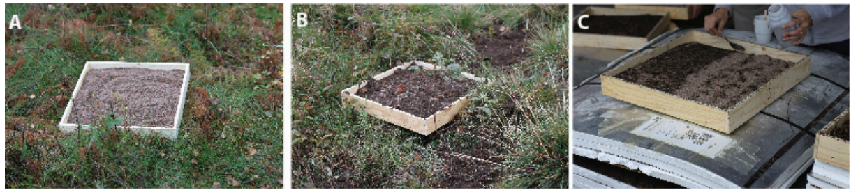
Figur 5. A – sandtråg före detonation, B – sandtråg efter detonation, C – provtagning ur tråg.
