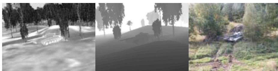
Figur 36. Till vänster visas en simulerad reflektansbild för en stridsvagn T72. I mitten visas en simulerad avståndsbild där ljusare bildpunkter är längre bort. Till höger visas ett foto som visar 3D-lasersensors synfält.
