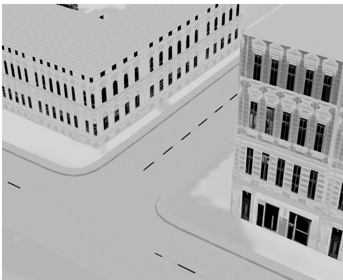
Figur 6. Registrering från en simulerad LWIR-sensor över ett område i Norrköping. Sensorupplösningen är 1024 \times 1024 pixlar.
