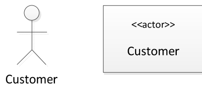
Figur 3 Grafiska symboler i UML som båda betecknar begreppet aktör (Moody, 2011a, s.21)
