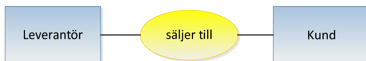
Figur 7 Exempel på hur entiteter och relationer i ER-diagram skulle kunna förbättras med både förändrad form och färg (Moody, 2009, s. 763)
