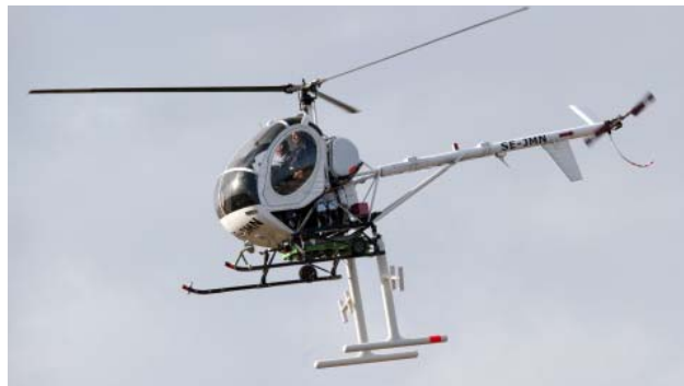
Figur 8. SAABs SAR-system CARABAS-3 installerat på helikopter Schweizer 300 tillhörande Malmkogens Aerocenter AB. Antennsystemet fälls ner av radaroperatören efter start och återförs i parkeringsläge inför landning. Den sistnämnda positionen intas även automatiskt i händelse av spänningsbortfall. De två horisontella antennelementen utnyttjas vid mätningar på LVHF-bandet och kan programmeras att samverka så att radarbelysning och mottagning kan styras mot höger eller vänster sida om helikoptern. För HVHF-bandet finns identiska antennelement på båda stödbenen och val av sida görs i detta fall genom att operatören aktiverar aktuell antenn. (Foto: SAAB / Stefan Kalm).
