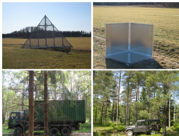
Figur 9. Två typer av radarreflektorer användes som referensobjekt vid mätningar med CARABAS-3 under 2012. En större 5 m hög trihedral (överst vänster) och en mindre reflektor med sidlängden 1 m (överst höger). Båda typerna fanns utplacerade på öppna fält nära den södra strandlinjen av sjön Roxen. Vid de inledande FOPEN-försöken kring FOIs mätplats Lilla Gåra utnyttjades fordonstyper av två olika storleksklasser. De nedre fotona visar dessa i position på två av totalt sju olika platser i skoglig terräng som utnyttjades vid SAR-registreringar under ett antal flygpass.
