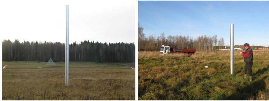
Figur 4. Ventilationsrör av längderna 6 m (vänster) och 3 m (höger) placerades ut inom försöksområdet på MSS Kvarn. Referensmålen är främst avsedda för analys av SAR-registreringar längs de cirkulära flygbanorna. I bakgrunden till det högre röret syns också en 5 m hög trihedral.
