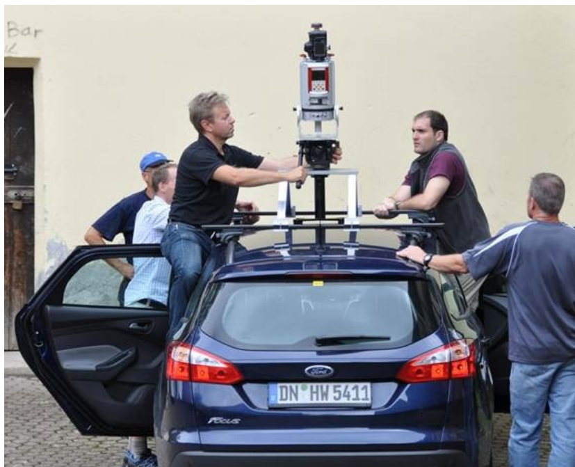
Figur 8. Riegl VZ-400 monterad på biltak. Från ett tidigare fältförsök i tyska Bonnland.
