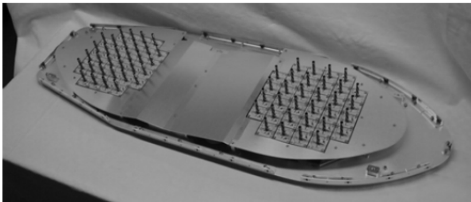
Figur 7: Gruppantenner för satellitkommunikation. L-bandsantenn på en flygplansrygg (a). Två sfäriska gruppantenner (b). En S-bandsantenn med helix-element (c).
