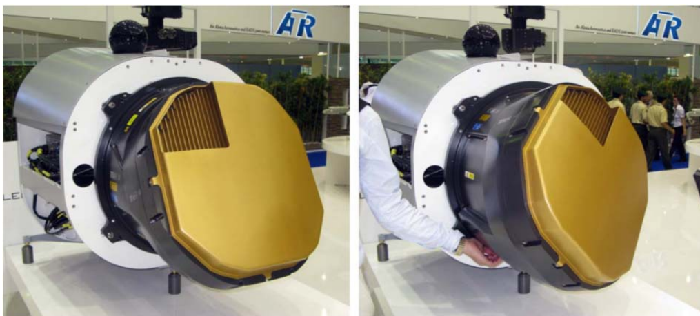
Figur 16: ES-05 Raven AESA vid X-band utvecklad för Gripen [11].
