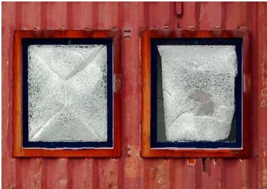
Bild 1. Fönsterrutor med Anti Shatter Film (bild från försök i Tyskland). Fotograf: Annika Lööf.
