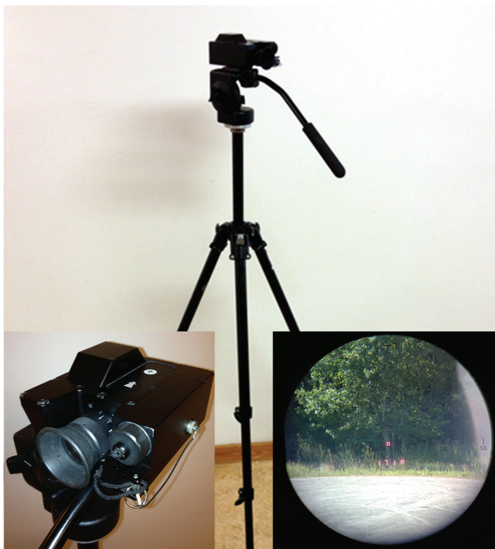
Figur 7. Överst bild på PLRF-en monterad på kamerastativ. Nederst till vänster bild på PLRF:ens framsida och till höger bild genom PLRF:ens okular som visar instrumentets kompassriktning i grader med röda siffror.
