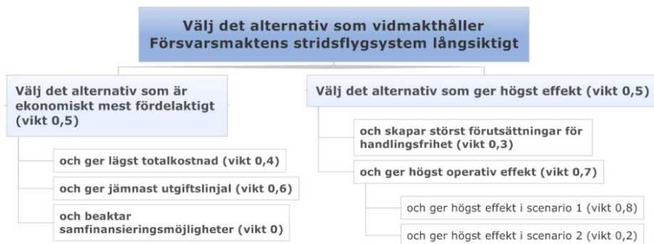
Figur 4 Exempel på en kriteriestruktur för variationsanalysen. Inom parentes anges kriteriets skattade vikt. Den skattade vikten varieras senare för att dra slutsatser om förändrade utfall och brytpunkter.
